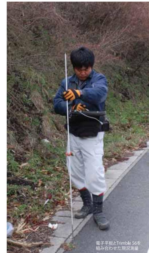
電子平板とTrimble S6を組み合わせた現況測量
