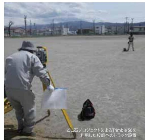
ここ石プロジェクトによるTrimble S6を利用した校庭へのトラック設置
